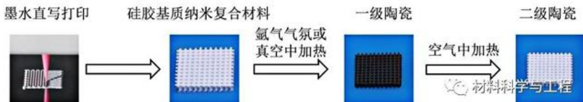
图 1 3D 打印陶瓷的过程示意图
